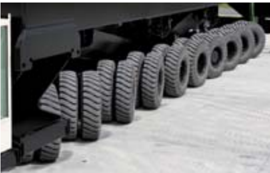
Ejes con dirección independiente para radios de giro mínimos y el menor desgaste de neumáticos
