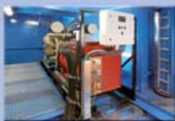
Generador Diesel dentro de la misma grúa
