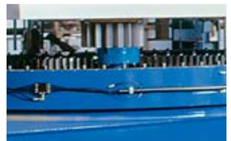
El piñón del mecanismo de giro transmite la fuerza a la corona de giro con dentado interior que incorpora un rodamiento de tres hileras de rodillos
