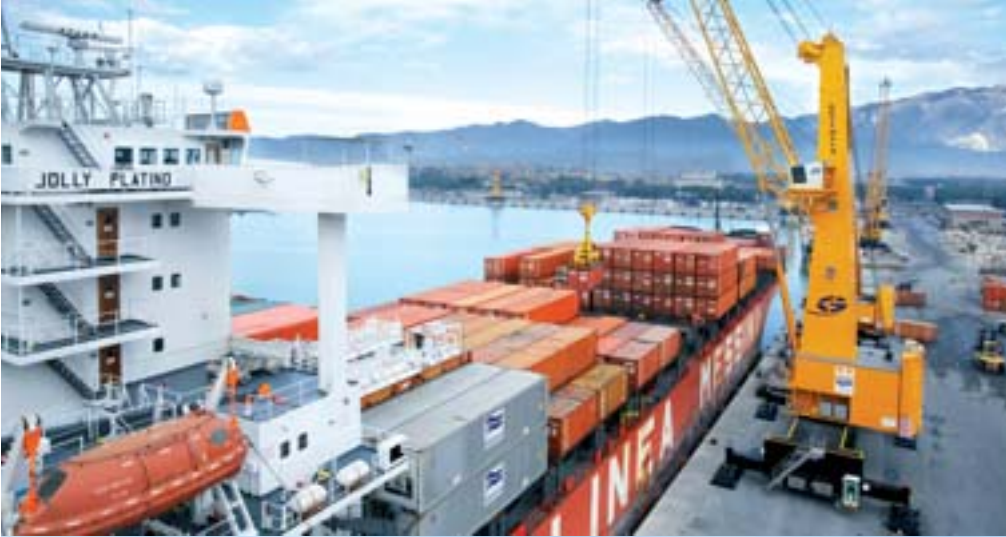
Grúa móvil de puerto G HMK 8710 manipulando contenedores en un buque Panamax
